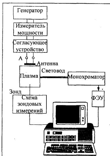
Рис. 2. Схема экспериментальной установки
