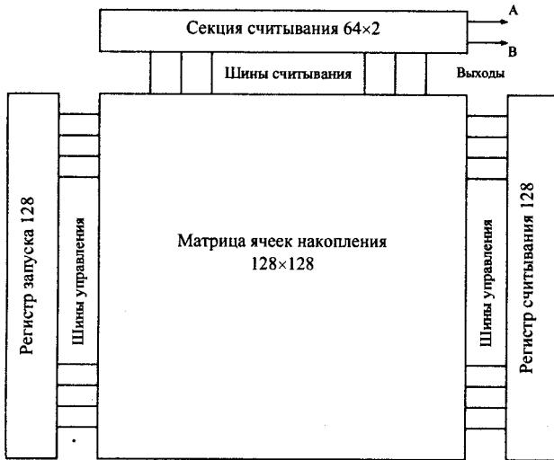
Рис. 1. Кристалл БИС считывания  $128 \times 128$  с накоплением в ячейке (структурная схема)
