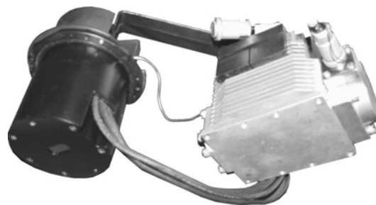
Рис. 2. 96-канальное фотоприемное устройство с МКС, закрепленное на технологическом кронштейне
