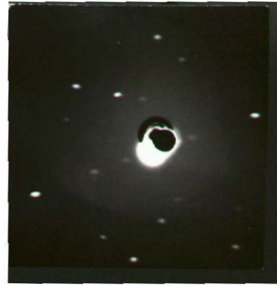
Рис. 3. Лауэграмма, полученная из последнего участка выращенного кристалла
