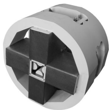
Рис. 1. Дублет магнитных квадрупольных линз новой конструкции
