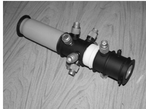
Рис. 2. Общий вид фотоэлектронной пушки с нестационарными электрическими полями, предназначенной для TRED-экспериментов
