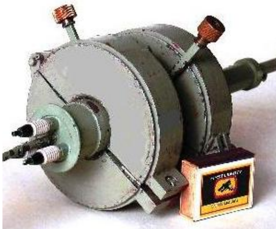
Рис. 2. Общий вид мощного импульсного пакетированного КРВ средневолновой части миллиметрового диапазона с низковольтным управлением током пучка по управляющему электроду ( V_0 = 18 кВ; I_0 = 0,5 А, U_c = (+200 В) — (–1,1 кВ)
