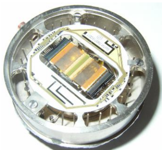
Рис. 1. Конструкция ФПУ (вид со снятой крышкой)
