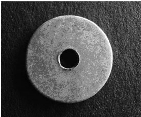
Рис. 3. Фотография образца из титанового сплава ВТ-1-0 (с увеличением 7) после формирования микро рельефа с помощью МПР
