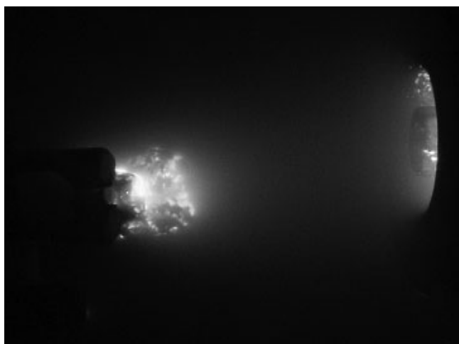
Рис. 1. Фотография МПР (в центре), возбуждаемых на поверхности образца диаметром 12 мм из титанового сплава VT-1-0 потоком плазмы из инжектора диаметром 2 см (справа)
