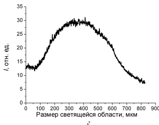
Рис. 4. Пространственное распределение интенсивности излучения плазмы для ТАЦ-мишени на длинах волн: а — 1,06 мкм; б — 0,707 мкм; в — 0,53 мкм; г — 0,424 мкм
