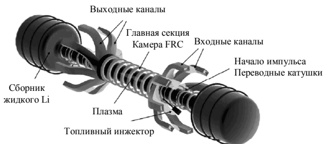
Рис. 6. Реактор на основе FRC — схема с жидким литием в качестве материала первой стенки для пристеночной откачки и наработки трития
