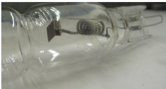
Рис. 2. Внешний вид потенциального защитного экрана с танталовой пластинкой, ориентированной в сторону плазмы
