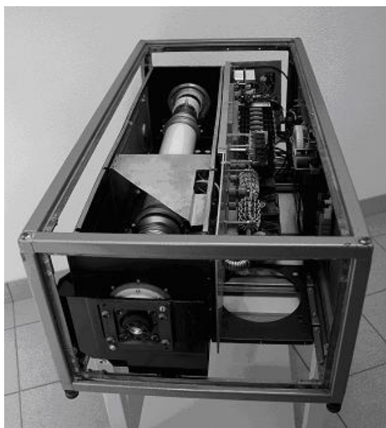
Рис. 3. Лазер на парах меди со снятыми стенками экранирующих кожухов
