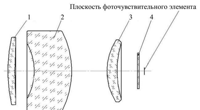
Рис. 2. Оптическая схема объектива: 1, 2, 3 — линзы; 4 — входное окно фотоприемника
