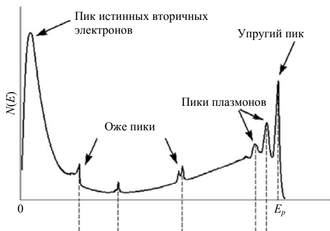
Рис. 2. Типичный спектр характеристических потерь (вторичных) электронов вблизи энергии первичных электронов E_p
