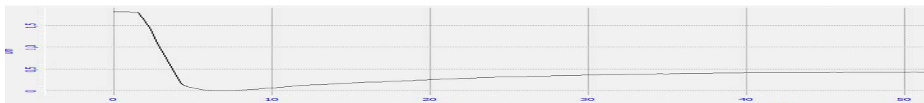
Рис. 2. Изображение профиля поверхности эпитаксиальной структуры Cd_xHg_{1-x}Te после полирующего травления в течение двух минут в системе H_2O_2 - HBr -этиленгликоль-метанол при покрытии фоторезистом левой части образца, полученное на атомно-силовом микроскопе Integra Maximus
