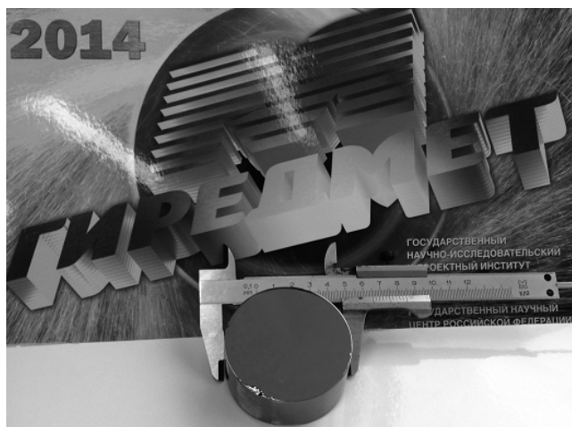
Рис. 1. Монокристалл Cd_{0,96}Zn_{0,04}Te диаметром 65 мм, выращенный на затравку
