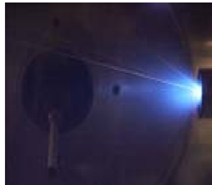
Рис. 2. Фотография свечения плазменного потока инжектора: справа — выходное сопло плазменного инжектора диаметром 30 мм
