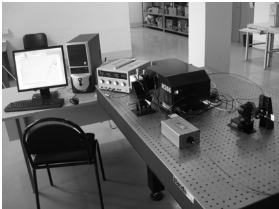
Рис. 2. Внешний вид установки измерения спектральной характеристики
