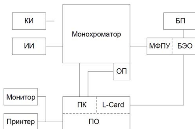
Рис. 1. Структурная схема установки измерения спектральной характеристики: КИ — контрольный источник; ИИ — источник излучения; ПК — персональный компьютер; ПО — программное обеспечение; ОП — опорный приемник; L-Card — плата ввода; БП — блок питания; МФПУ — измеряемый приемник; БЭО — блок электронной обработки
