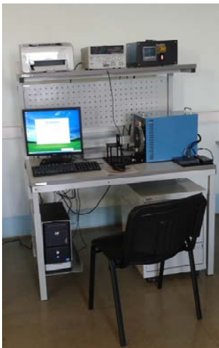
Рис. 2. Внешний вид автоматизированного стенда для измерения основных параметров МФПУ на основе InGaAs
