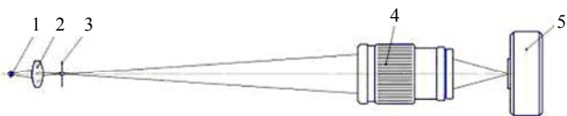
Рис. 3. Схема для контроля величины и распределения энергии в пятне рассеяния: 1 — фиолетовый светодиод; 2 — конденсор; 3 — точечная диафрагма; 4 — контролируемый объектив; 5 — камера-окуляр
