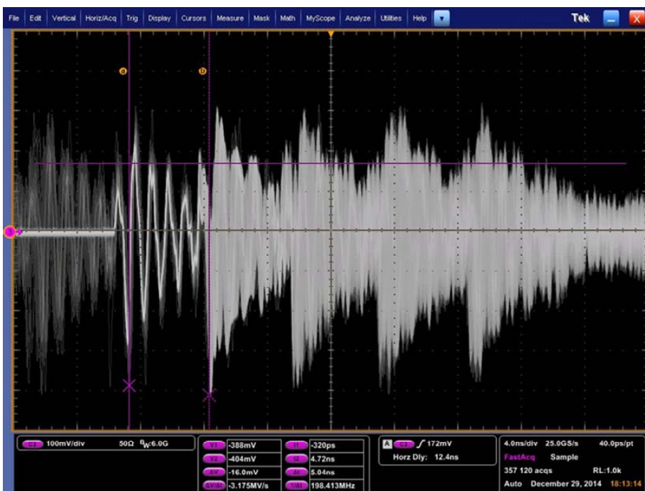
Рис. 4. Последовательность из пяти сгустков при энергии 450 МэВ
