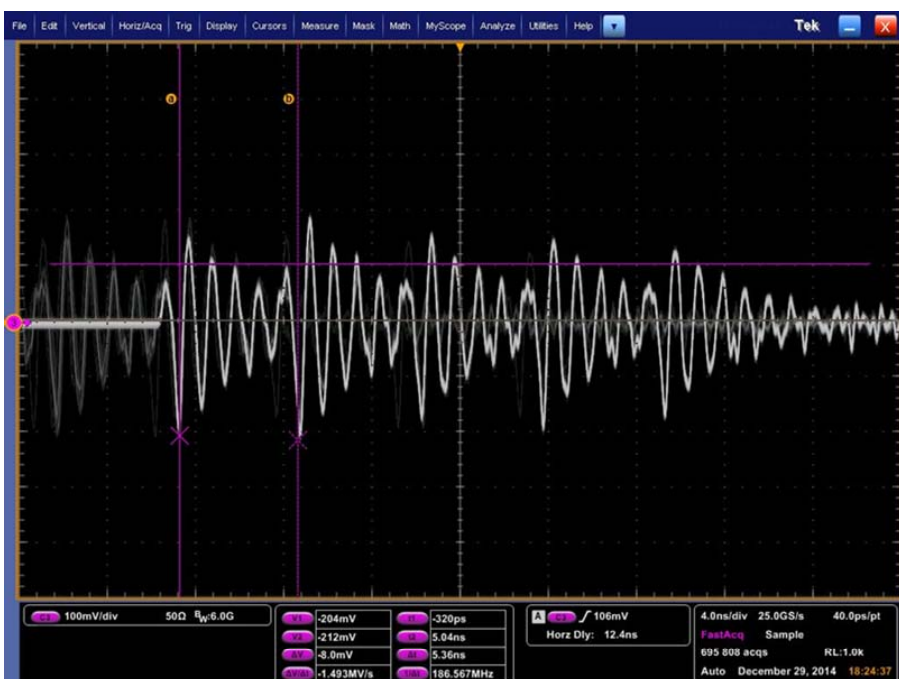
Рис. 5. Последовательность из пяти сгустков при энергии 2,5 ГэВ
