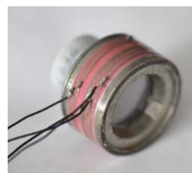
Рис. 5. Вакуумный блок фотоэлектронного прибора с ОЭС фотокатодом GaN/GaAlN
