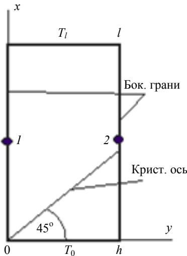
Рис. Схема образца для исследования поперечного перепада температуры.
