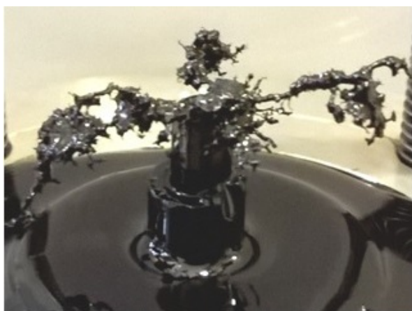
Рис. 3. Древоподобная структура на конце электрода после разряда в продукте гидроконверсии.
