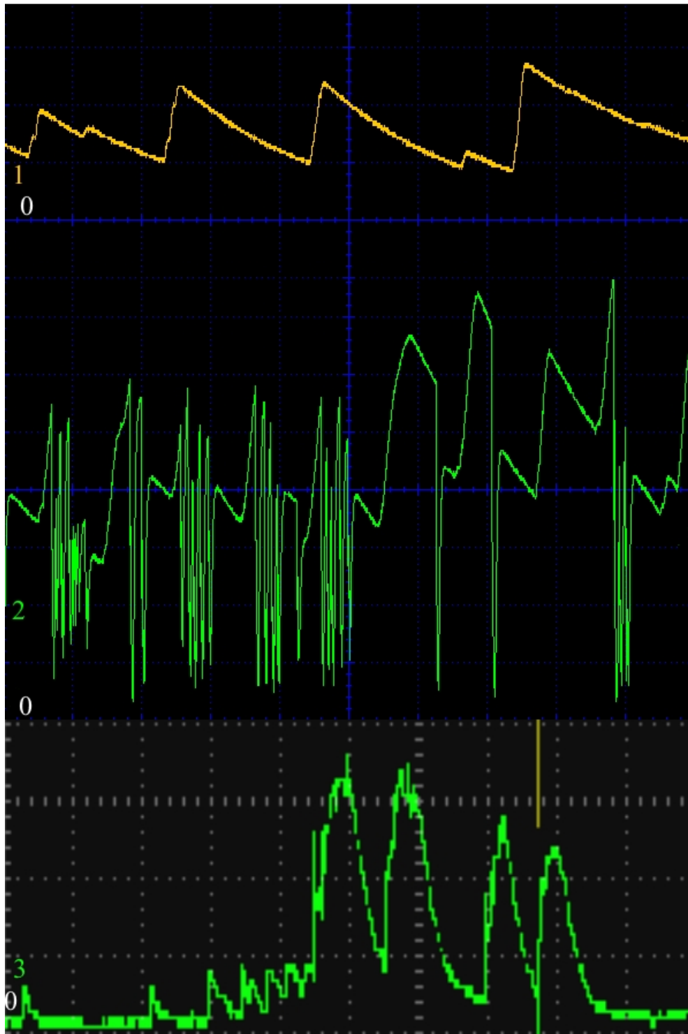
Рис. 2. Осциллограмма напряжения и тока: 1 — колебания напряжения на разрядном промежутке при подаче напряжения меньше пробивного (цена деления 13,5 кВ/дел, развертка 10 мс); 2 — напряжение разряда (цена деления 13,5 кВ/дел, развертка 10 мс); 3 — ток разряда (цена деления 3 мА/дел, развертка 1 мс).
