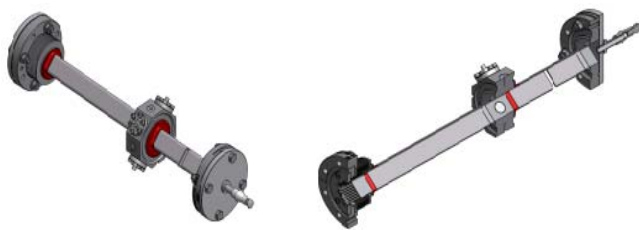
Рис. 1. Трехмерное изображение вакуумной камеры ондулятора.
