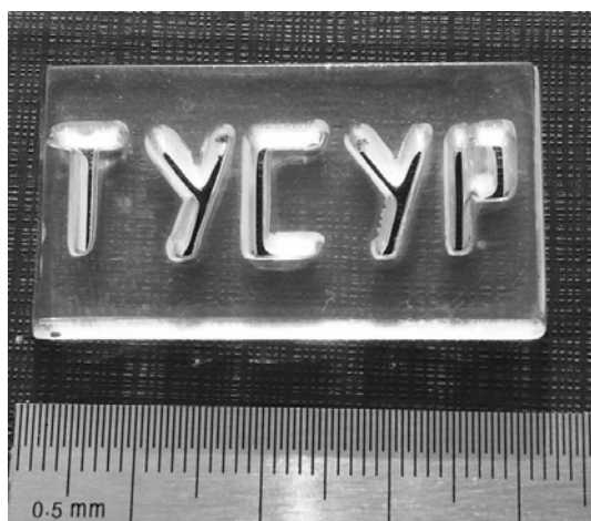
Рис. 4. Образец фрезерования сложного профиля электронным пучком в кварцевом стекле.
