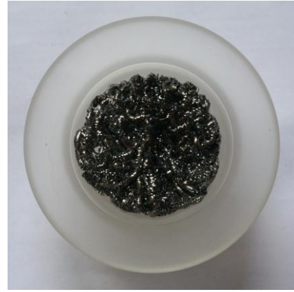
Рис. 2. Фотография инициатора подпорогового микроволнового СНС-разряда.
