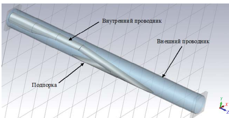
Рис. 2. Конструкция предлагаемого выходного преобразователя мод в программном комплексе CST Studio Suite 2015.
