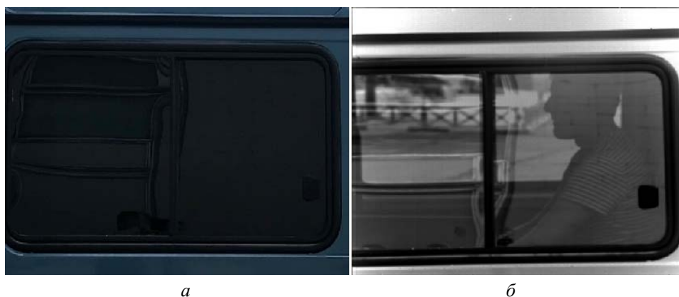
Рис. 10. Тонированное стекло (светопропускание 5 %) в видимом (а) и в коротковолновом ИК (б) диапазонах спектра.
