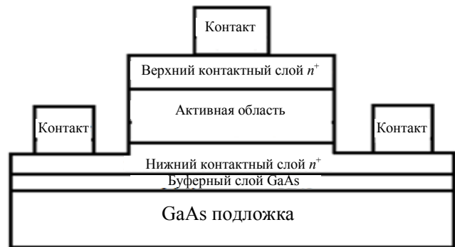
Рис. 1. Схематичное изображение тестовых образцов небольших размеров на основе QWIP GaAs/AlGaAs-структур с металлическими контактами.
