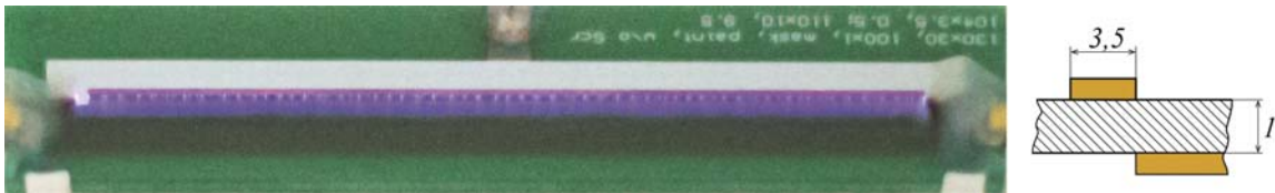
Рис. 3. Фотография разряда горящего на актуаторе (слева) и поперечный разрез актуатора (справа).
