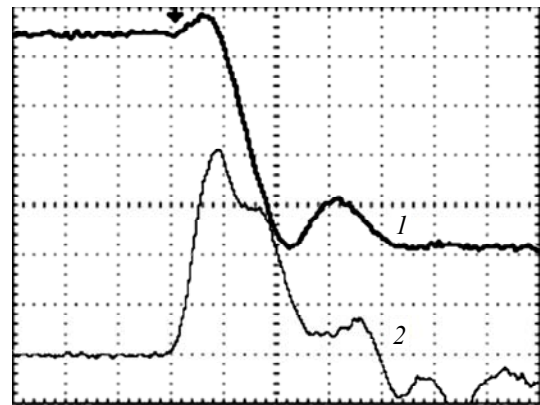
Рис. 1. Осциллограмма. Развертка 10 нс/дел. Луч № 1 – напряжение на промежутке катод-анод, чувствительность – 200 В/дел. Луч № 2 – ток поджига, чувствительность – 2 А/дел.
