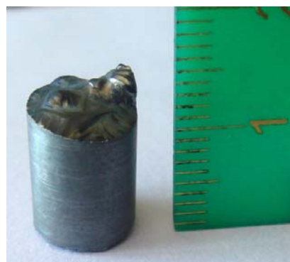
Рис. 2. Фотография образца кремния подготовленного для исследования содержания примесей.
