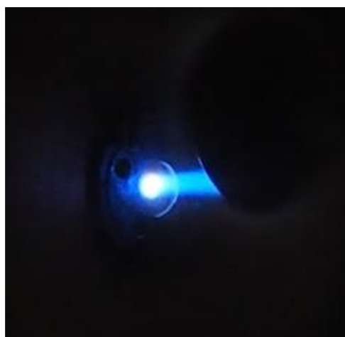
Рис. 4. Инжекция электронов в импульсном режиме работы эмиттера: а) ток в цепях разрядной системы в зависимости от потенциала коллектора (диаметр отверстия 1 мм); б) фотография пучка электронов в области эмиссионного отверстия (диаметр отверстия 3 мм). Ток эмиттерного разряда 12,5 А (25 мкс), L = 10 мм, p = 0,09 Па
