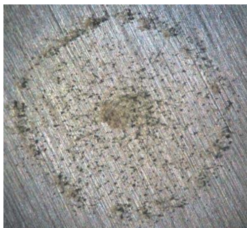
Рис. 2. Фото поверхности контрольного образца без слоя оксида титана после испытаний в условиях минеральных и органических загрязнений (Метод 3)
