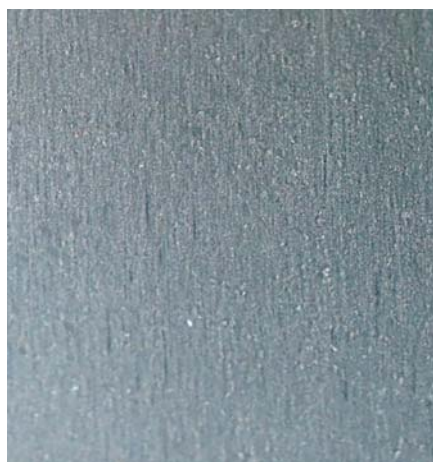
Рис. 3. Фото поверхности образца с нанесенным слоем оксида титана после испытаний в условиях минеральных и органических загрязнений (Метод 3)
