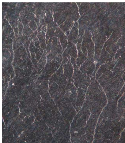
Рис. 2. Фото поверхности контрольного образца без слоя диоксида титана после полевых испытаний в условиях естественных минеральных и органических загрязнений. Увеличение – 10
