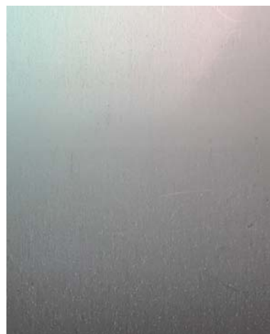
Рис. 3. Фото поверхности образца с нанесенным слоем диоксида титана после полевых испытаний в условиях естественных минеральных и органических загрязнений
