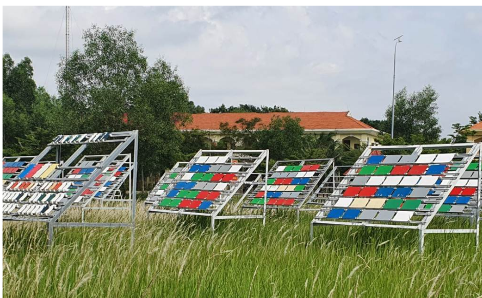
Рис. 1. Фото экспозиционных стендов для испытаний образцов различных материалов на открытой площадке климатической испытательной станции в условиях тропического климата Вьетнама (Хошимин)
