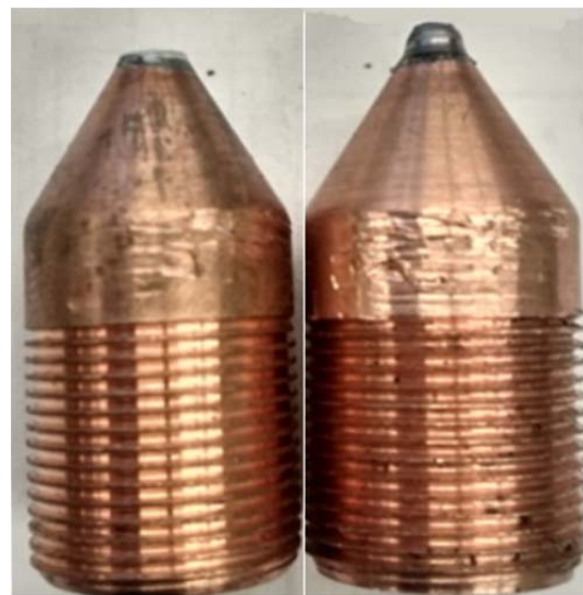
Рис. 2. Фото катода: слева – после ресурсных испытаний до добавления пропан-бутана, справа – катод через 3 минуты после добавления пропан-бутана
