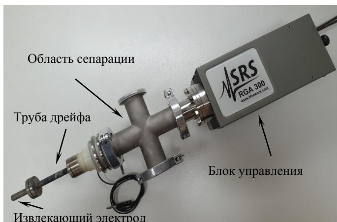
Рис. 2. Модернизированный квадрупольный масс-анализатор RGA-300
