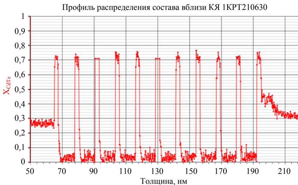
Рис. 2. Профиль распределения состава n Вп-гетероструктуры КРТ в области барьера для 10-ти периодной сверхрешетки
