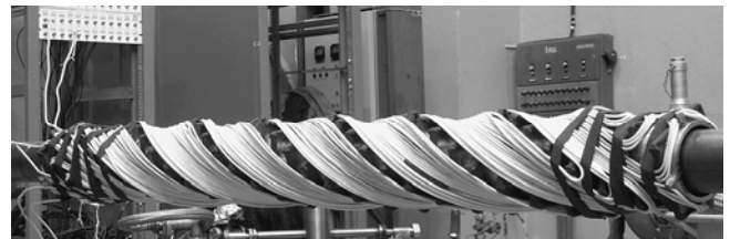
Рис. 2. Спиральный квадруполь. Геометрическая длина квадруполя равна двум шагам спирали
