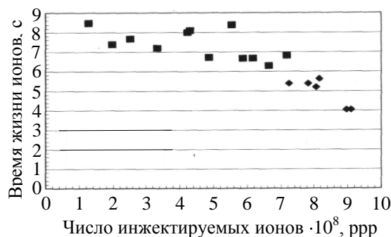
Рис. 4. Зависимость времени жизни накопленных и вновь инжектируемых ионов от их интенсивности при T_{inj} = 1,65 с, R = 2 и I = 125 мА: ◆ — вброс (инжекция) ионов; ■ — уход (распад) ионов
