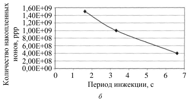
Рис. 6. Зависимость интенсивности накопленных ионов от тока электронного пучка и периода инжекции: а — R = 3,3 и T_{inj} = 1,65 \text{ с} ; б — I_e = 100 \text{ мА} и R = 3,3
