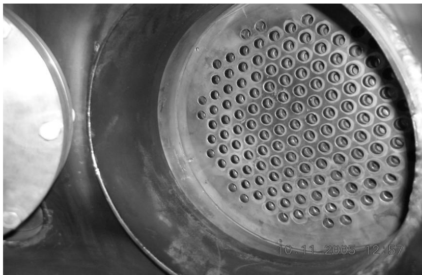
Рис. 8. Вид ионного источника со стороны вакуумной камеры
