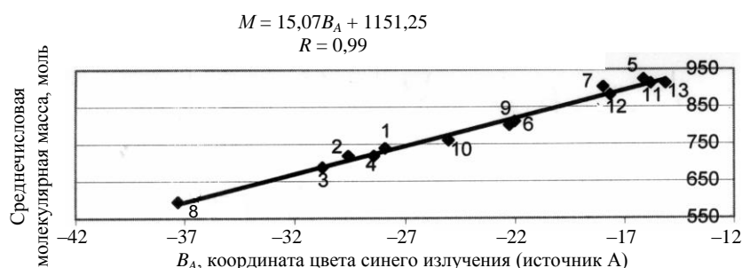
Рис. 1. Корреляция среднечисловых молекулярных масс различных битумов и координат цвета синего излучения (источник А):
