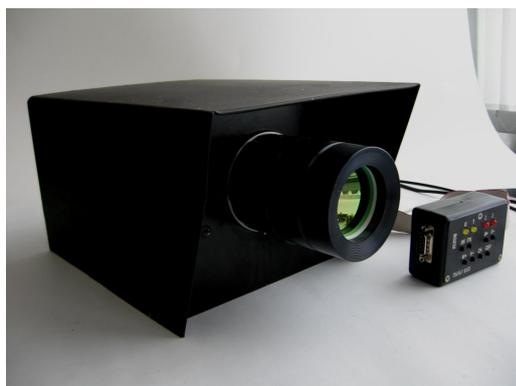
Рис. 1. Тепловизионный прибор на спектральный диапазон 3—5 мкм
