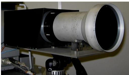
Рис. 6. Внешний вид макета тепловизионного канала с фокусным расстоянием 240 мм
