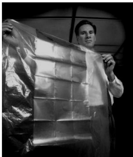
Рис. 5. Спиральные антенны на гибкой полиэтиленовой пленке
