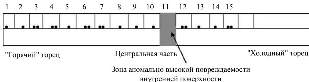
Рис. 5. Схема расположения анализируемых образцов вдоль трубы
