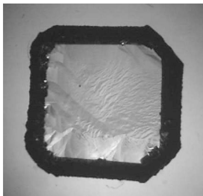
Рис. 5. Эпитаксиальный слой CVD-алмаза толщиной 600 мкм на HPHT-подложке размером 4,5×4,5 мм. Темная зона по краю — поликристаллическая алмазная пленка на торцевых гранях. Фото в оптическом микроскопе
