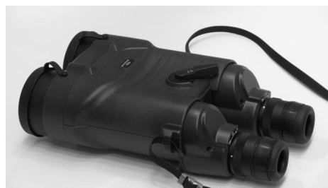
Рис. 1. Внешний вид бинокля со стабилизированным полем зрения
