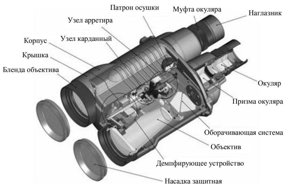
Рис. 2. Внутреннее устройство бинокля со стабилизированным полем зрения
