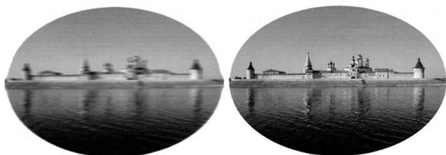
Рис. 4. Характер наблюдения в бинокль с подвижного основания при отсутствии стабилизации изображения (слева) и при ее включении (справа)
